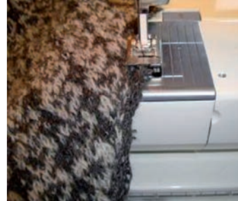
Sy en sicksacksöm längs varje klippt kant.
